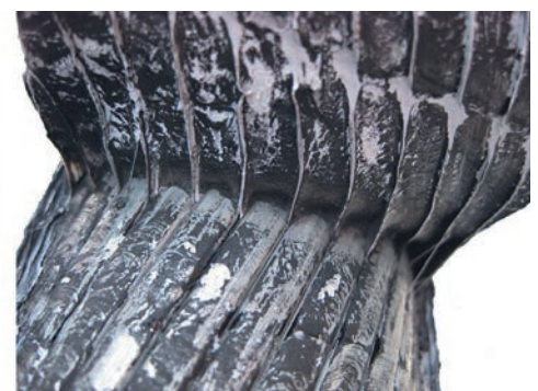
Bild 3. Kommt in jüngster Zeit immer häufiger zur Anwendung: ATIS Cableskin® zur dauerhaften Seilsanierung (Fotos: Alpin)
