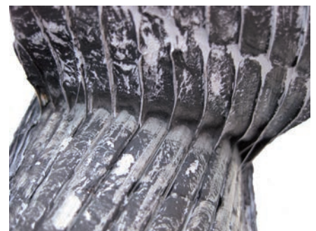
Bild 6. Haftung und Verzahnung der Basislage auf der Seiloberfläche
