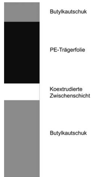
Bild 5. Aufbau des Korrosionsschutzbandes der Basislage
