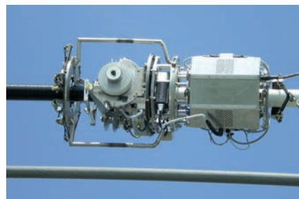
Bild 10. Wickelroboter Fig. 10. Wrapping robot
